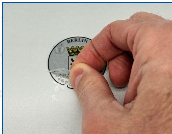
2 | Mit dem Finger bzw. Schaber die obere Folie der Stempelplakette vom Kennzeichen lösen.
